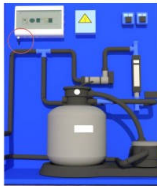
1.4.Подключение электрического кабеля к пульту
